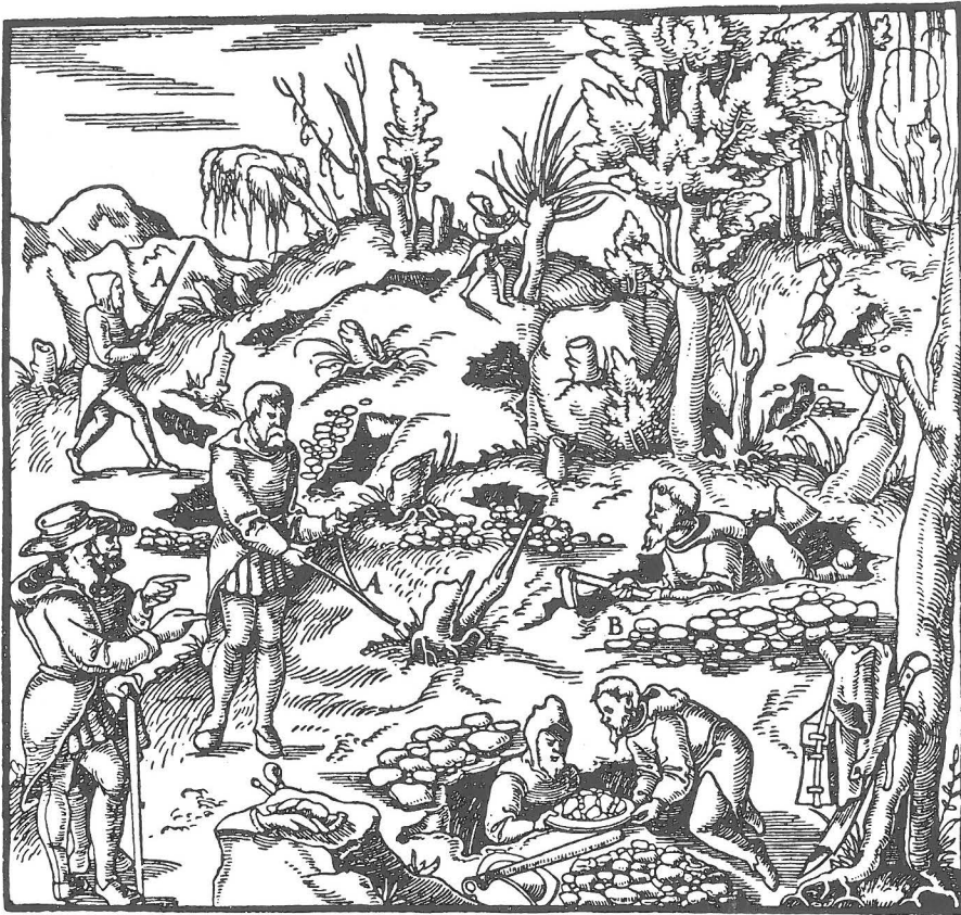
Aufsuchen der Gänge mit der Wünschelrute und durch Schürfgräben Holzschnitt aus dem Bergwerksbuch (de re metallica) von Georg Agricola, 1556
